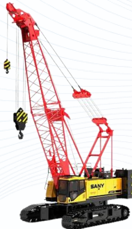
➤ Crawler Crane 100 Ton
